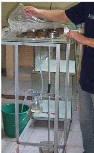
**Figura 4 – Mesa de tensão com anéis de solo indeformado.**
