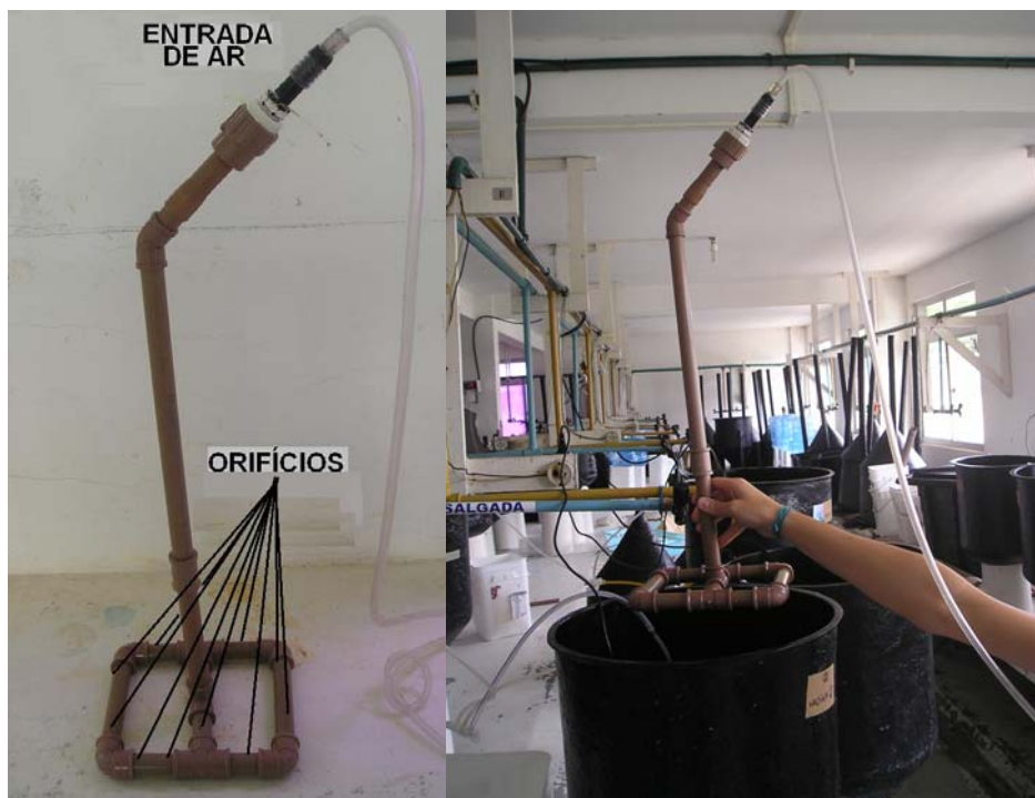
Figura 20. Homogeneizador e a posição adotada para a colocação no tanque.
