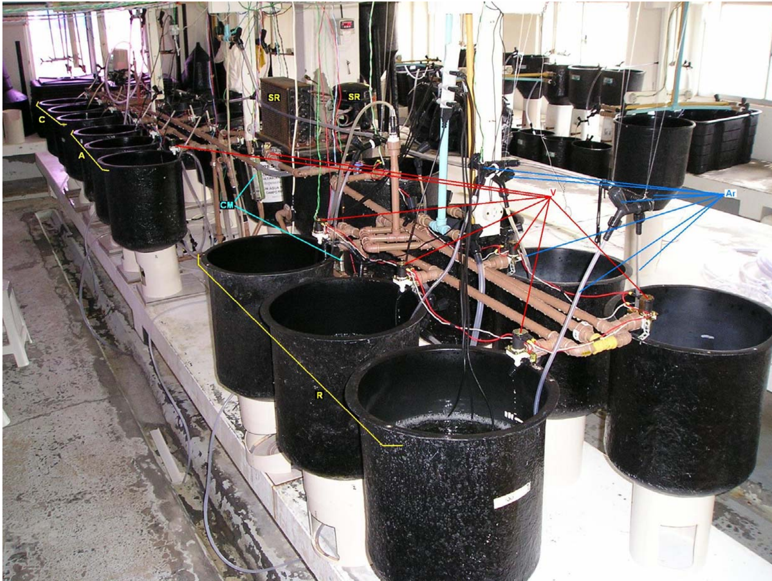
Figura 27. Vista Panorâmica da bancada experimental. R – Tratamento Ração Magnetizada. A – Tratamento Água Magnetizada. C – Tanques Controle. SR – Sistema de Refrigeração. Ar – Sistema de aeração dos tanques. V – Válvulas Elétricas. CM – Dispositivo do Campo Magnético.
