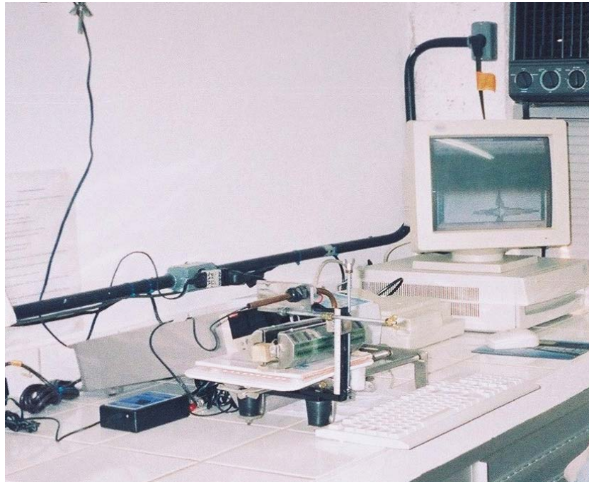
Figura 13. Mesa coordenada (Mc); dispositivo magnético (Dm) e Gaussímetro (Gm).
