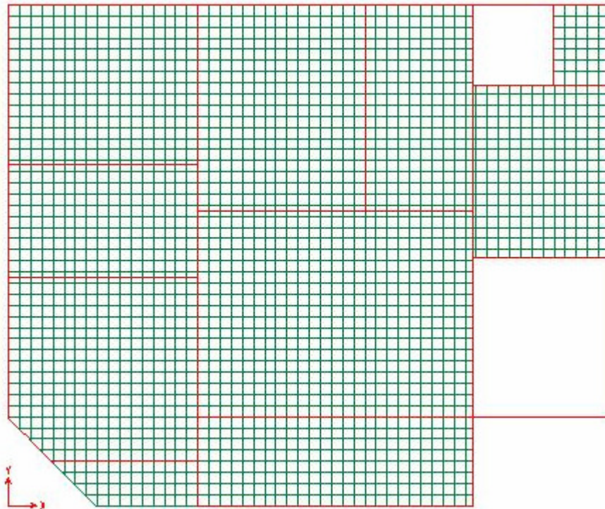
Figura 6.2 - pavimento modelado em analogia de gralha com malha coincidente de 25x25.
