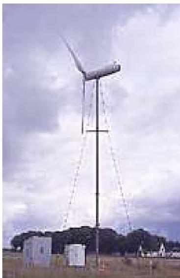
Figura 3.17. Aerogerador com rotor a sotavento (*downwind*).
