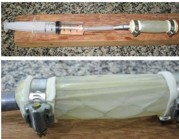
Figura 45 – Experimento do Protótipo 1 em dois momentos: sístole e diástole, respectivamente.
