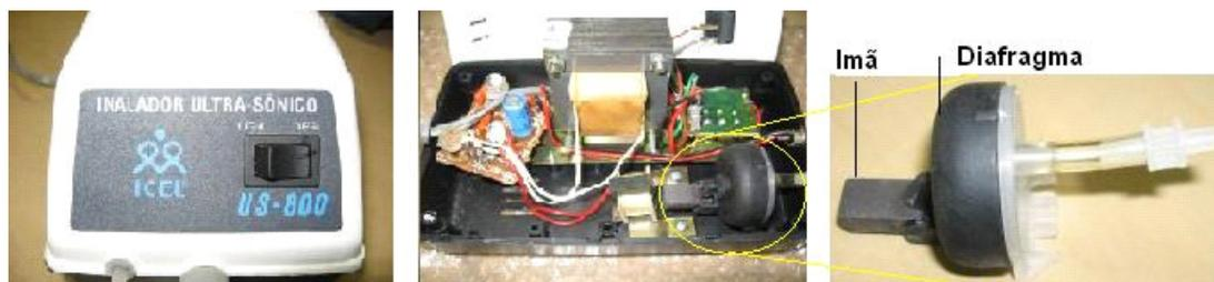
Figura 56 – Experimento com Nebulizador
