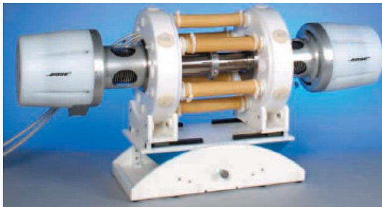
Figura 20 – Aparelho de teste de endoprótese da Electroforce (ELECTROFORCE, 2007).
