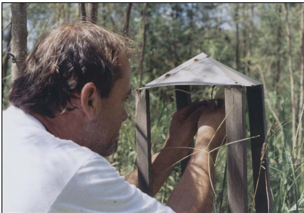
Foto 16 – Instalação do sensor de umidade relativa do ar – 2005
