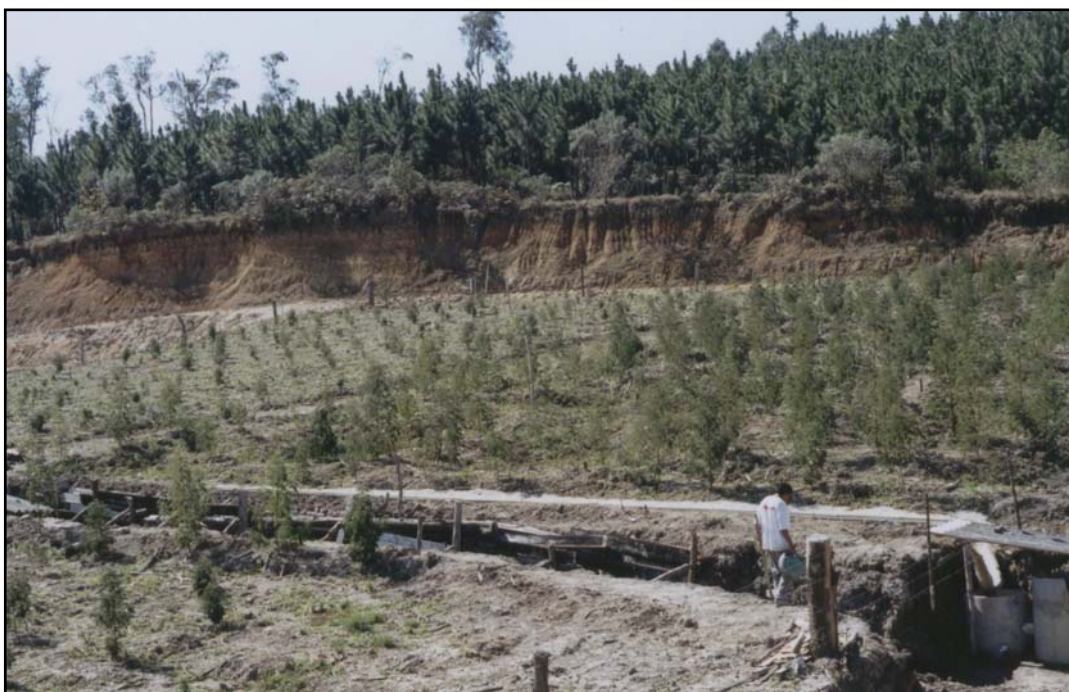
Foto 19 – Canaletas de concreto semi-circulares para avaliação da conservação da água e perdas do solo – 2004
