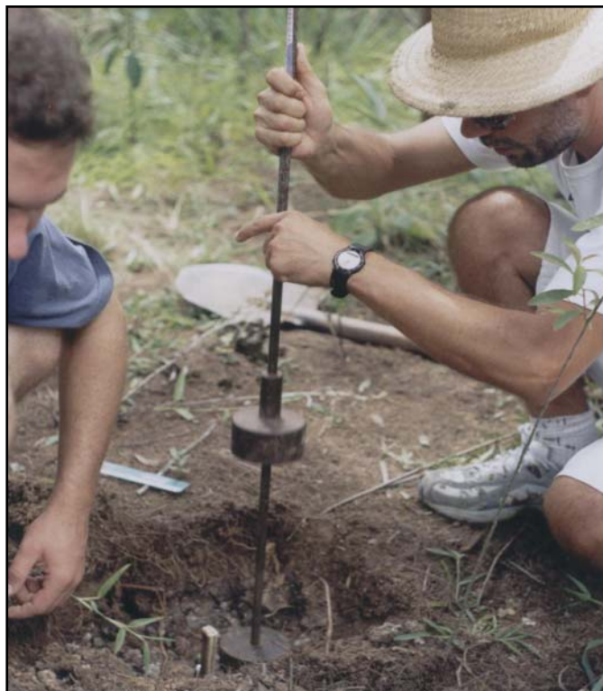
Foto 21 – Coleta de solo para análise das propriedades físicas – 2005
