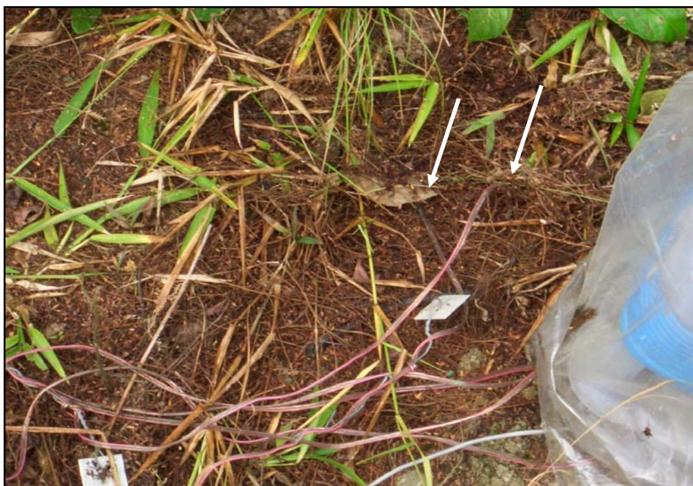
Foto 15 – Placas de alumínio para identificação do número do sensor de temperatura e a seta indica a sua posição no solo – 2006
