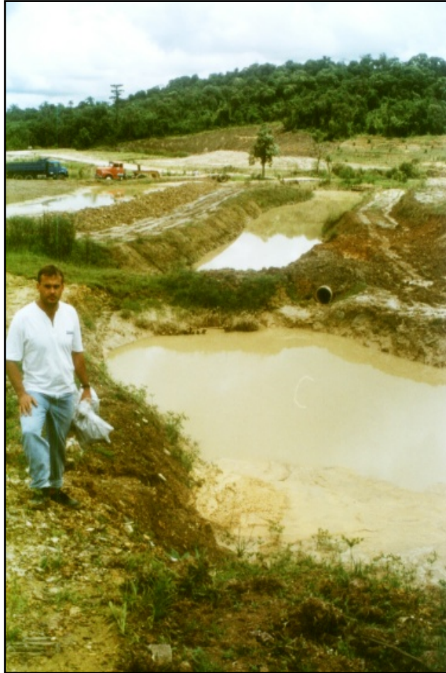
Foto 4 – Lagoas com filtros de brita para decantação dos sedimentos em área de mineração de Campo Formoso, no município de Doutor Pedrinho, SC – 1995
