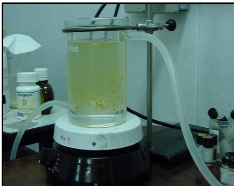
Figura 14 - Reator tipo batelada com enzima imobilizada e temperatura controlada.
