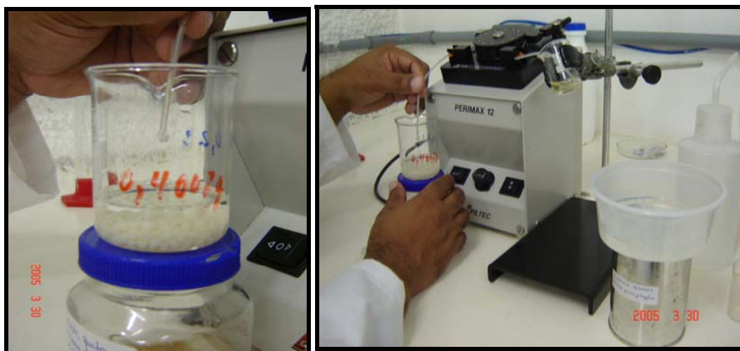
Figura 11 - Confeção das esferas de quitosana por banho de precipitação.
