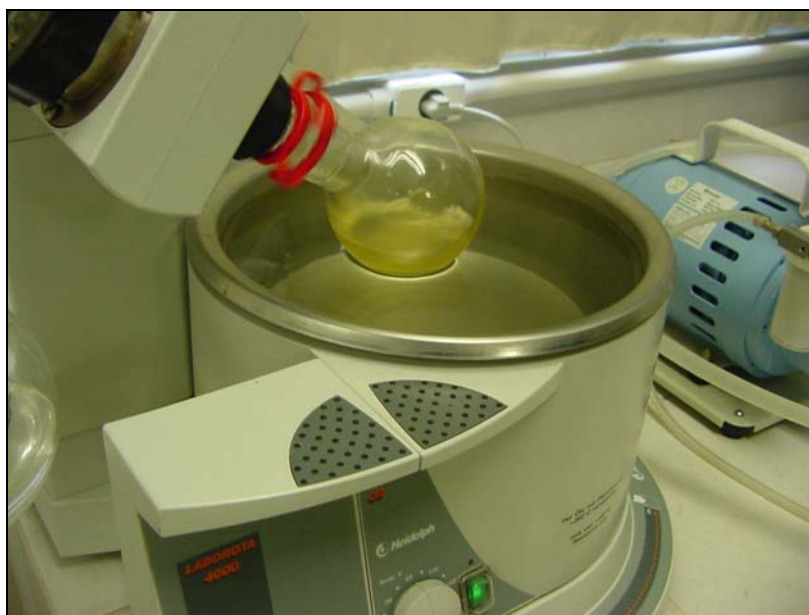
Figura 16 - Processo de separação do ricinoleato de etila em evaporador rotativo.
