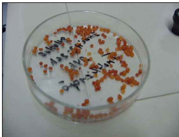
Figura 13 - Esferas de quitosana imobilizadas covalentemente com CALB L após reuso.
