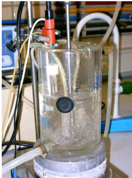
Figura 3.7 – Foto do reator experimental para a determinação da taxa de dissolução.
