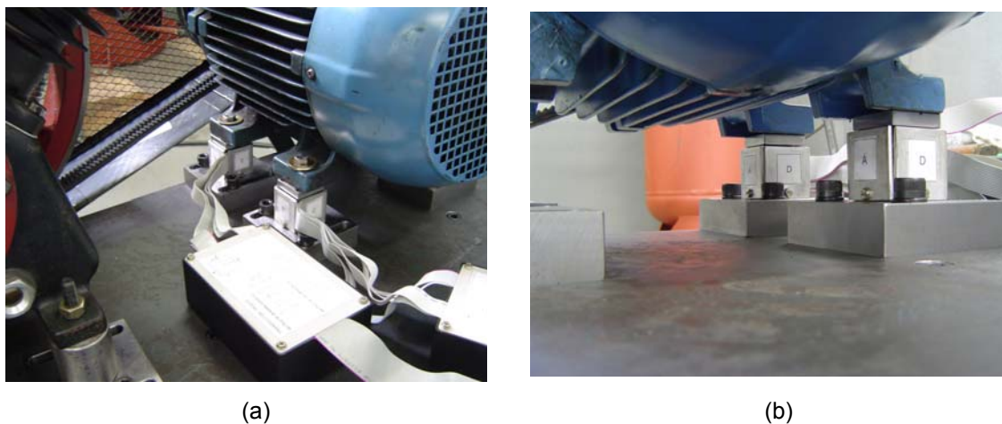
Figura 4.7 – Posicionamento dos transdutores no motor (a) PT5 e PT6 (b) PT7 e PT8.
