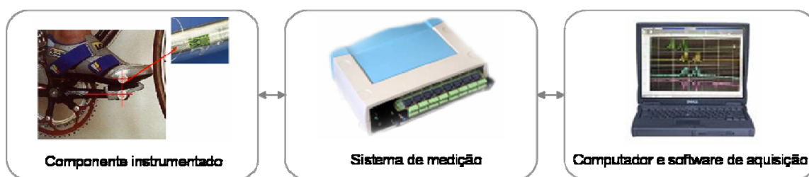
Figura 2.11 - Cadeia esquemática para medição em extensometria.
