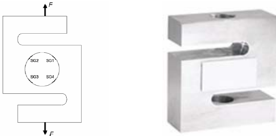
Figura 2.14 - Transdutor de carregamento axial com formato em "S".
