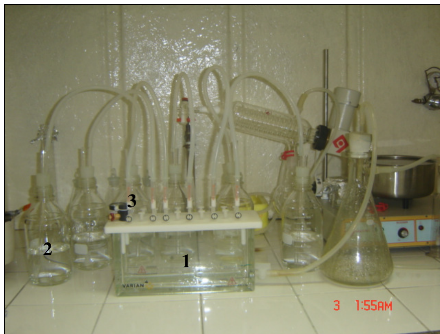
Figura 10 - Sistema de extração (manifold) (1) com a identificação da passagem da amostra (2) pelo cartucho (3).
