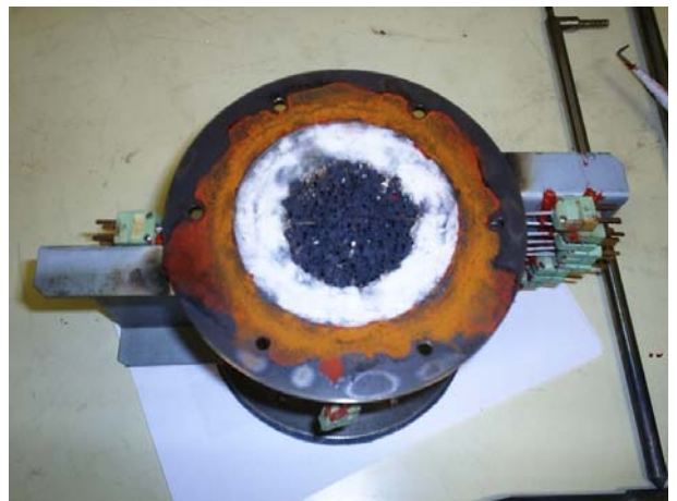
Queimador poroso radiante após o uso prolongado.
