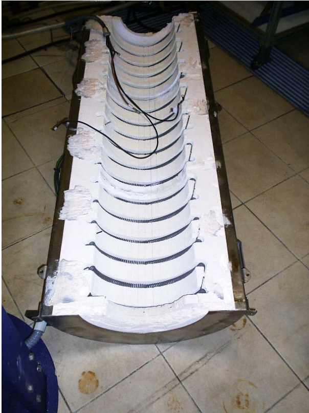
Paredes da fornalha com sistema de aquecimento.
