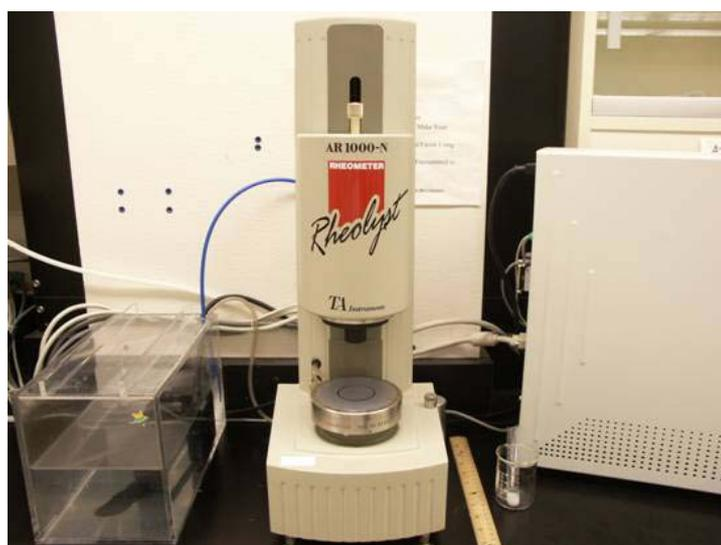
Figura 2 – Reômetro (Modelo AR 1000-N, TA Instruments, EUA).
