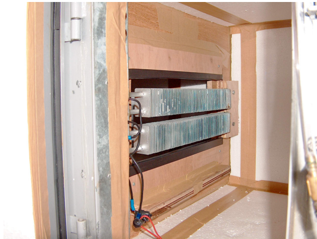
Figura 3.20 – Montagem das resistências elétricas
