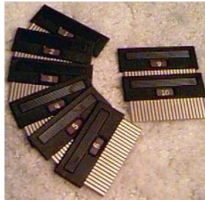
Fig. 8 Os jumpers, que permitiam trocar os jogos para o Odyssey 100.
