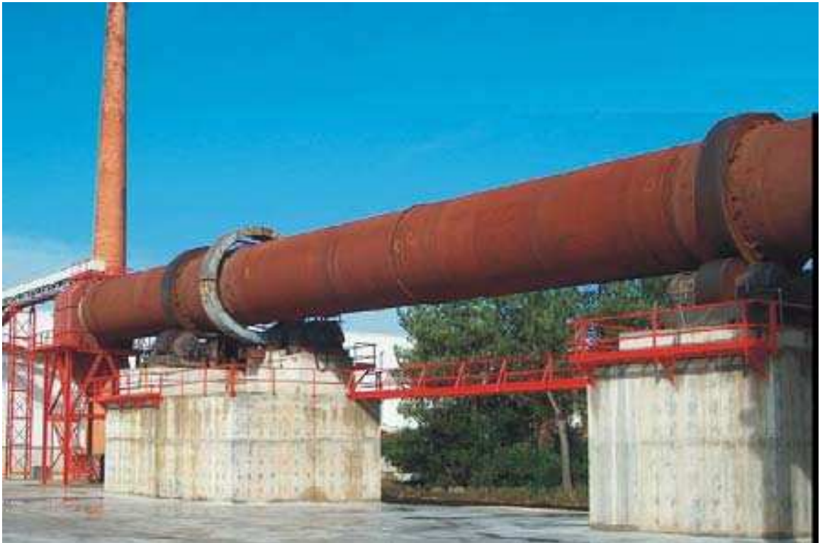
Figura 2.3 – Forno rotativo de 60 metros utilizado na produção de agregado de argila expandida (ARGEX, 2006).
