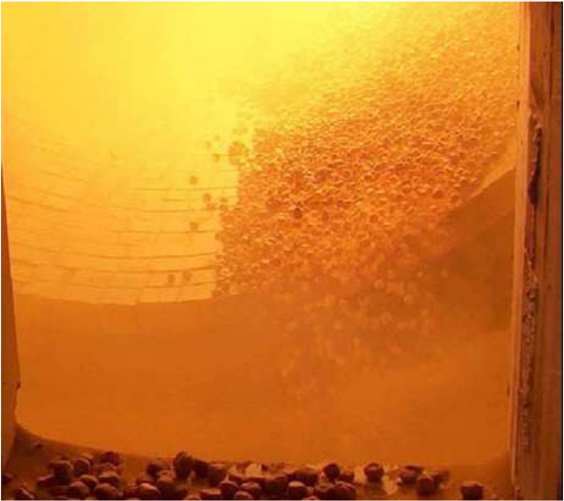
Figura 2.4 – Região de saída da carga no interior de um forno rotativo para a produção de agregado de argila expandida (ARGEX, 2006).
