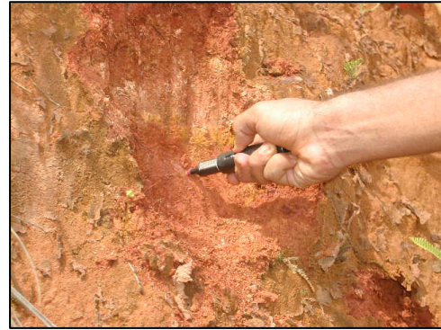
FIGURA 20 e 21: Ensaio de resistência do solo: cisalhômetro (esq.) e penetrômetro (dir.)
