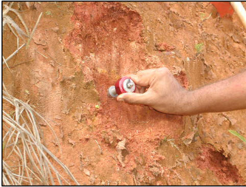
FIGURA 20 e 21: Ensaio de resistência do solo: cisalhômetro (esq.) e penetrômetro (dir.)
