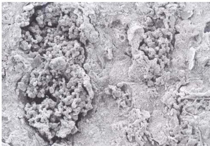
Figura 29 - Foto ampliada mostrando o aspecto da textura de colônia de fungos (Thomaz, 1992)
