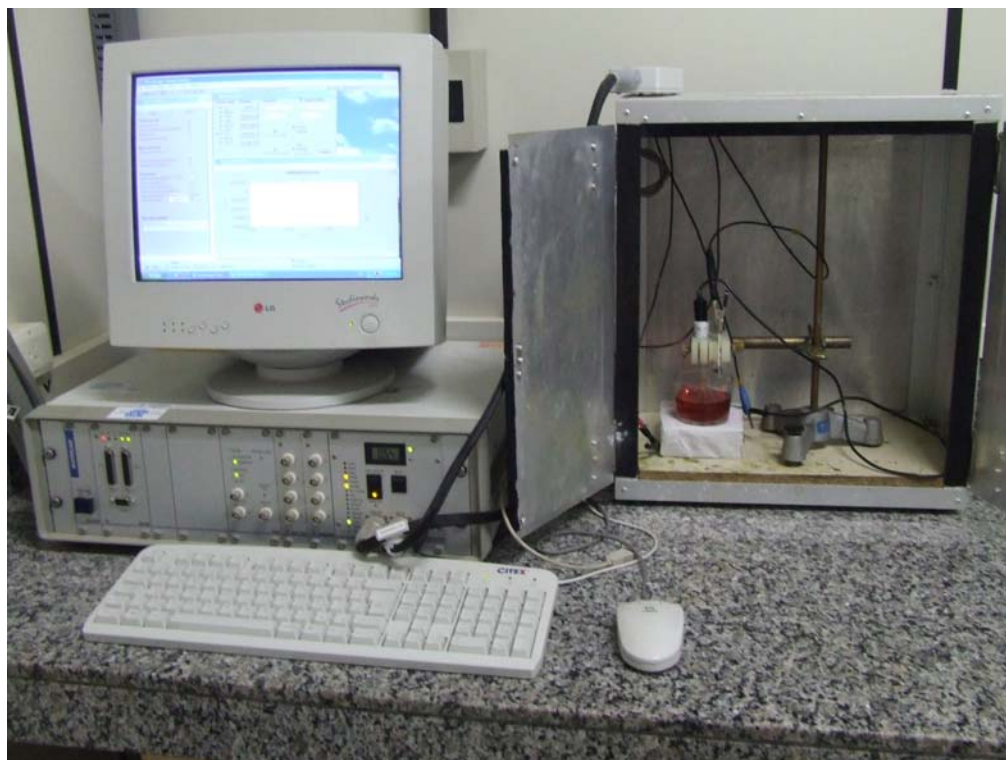
Figura II.2: Foto do aparato experimental utilizado nos experimentos eletroquímicos. Nela temos uma célula eletroquímica de três eletrodos colocada dentro de uma caixa de alumínio. A célula eletroquímica esta conectada a um potenciostato, interfaceado com um microcomputador.
