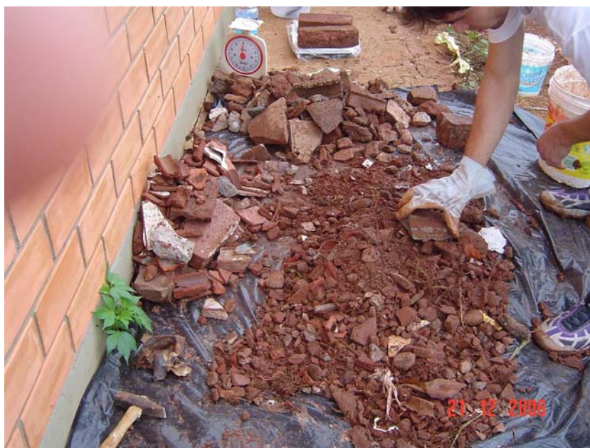
Figura 47 - Caracterização qualitativa dos RCD no município de Fred. Westphalen - RS
