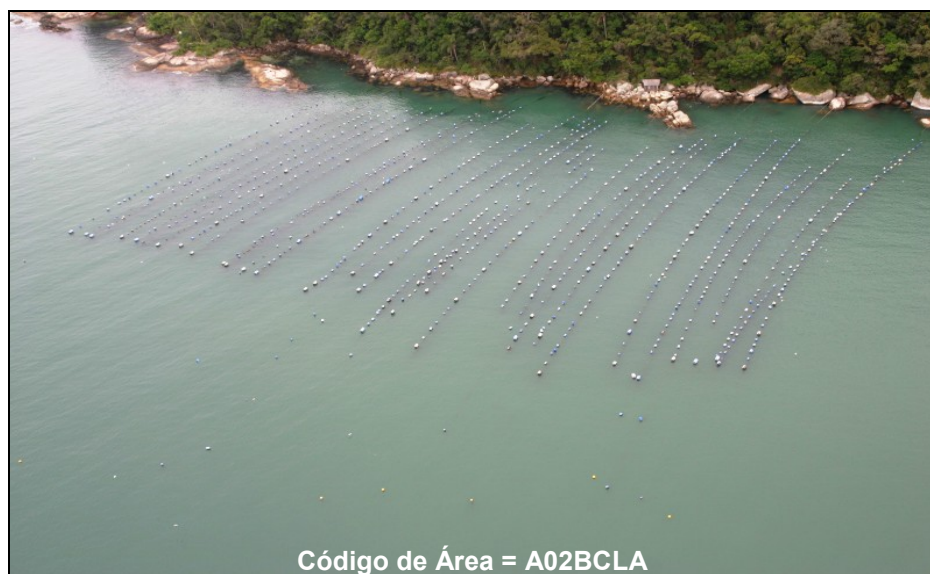
Figura 59 – “Long-lines” fixados ao costão rochoso no parque aquícola de Laranjeiras (município de Balneário Camboriú) Fonte: CEPSUL e Marinha do Brasil (2005)
