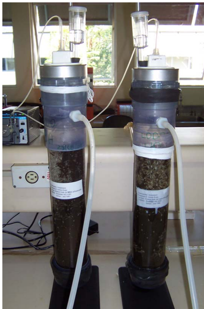
Figura 4.2: Reatores de vidro com material suporte de PVC e fluxo ascendente.
