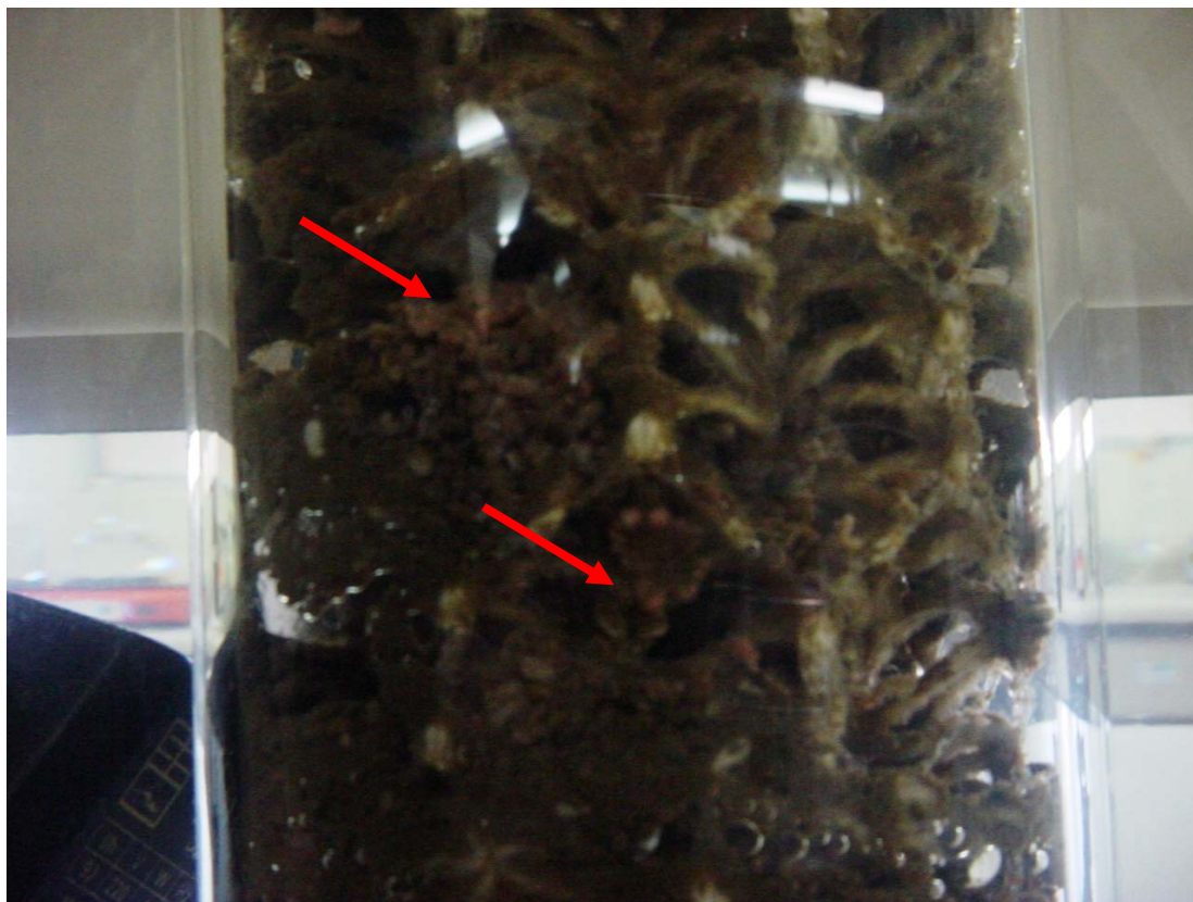
Figura 5.13: Foto tirada do Reator UD após o 200° dia de observação. Em destaque estão os aglomerados que se formaram durante a atividade do reator.
