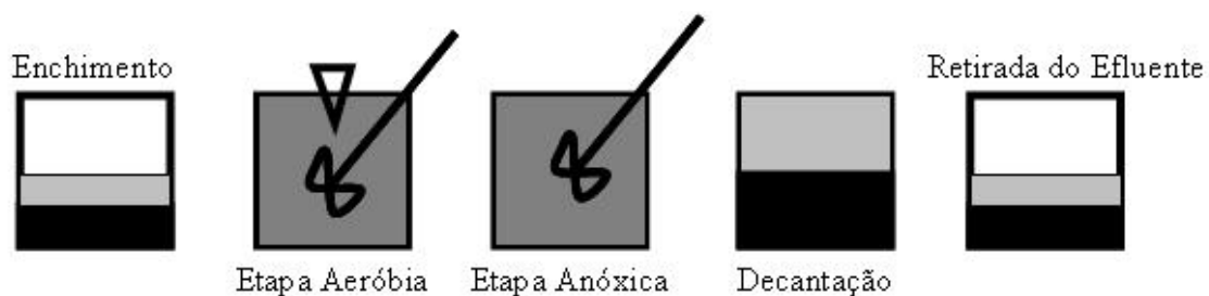
Figura 3.6: Esquema simplificado de nitrificação e desnitrificação no mesmo reator sob operação em SBR.
