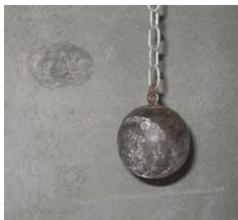
Figura 4.14 – Impacto de corpo duro, massa de 1 kg.
