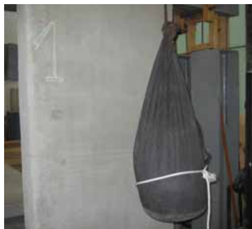
Figura 4.12 – Impacto de corpo mole no painel 1 ensaiado com massa 40 kg.
