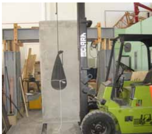
Figura 4.11 – Arranjo de ensaio para impactos de corpo mole.
