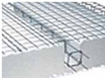
Figura 3.8 – Painel Piso com armadura adicional-unidirecional
