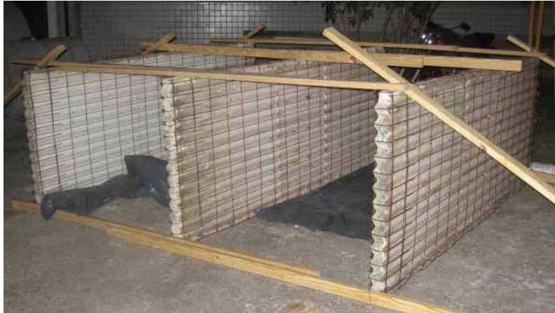
Figura 4.8 – Painéis a serem ensaiados sem revestimento
