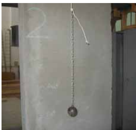
Figura 4.13 – Arranjo de ensaio para impactos de corpo duro.
