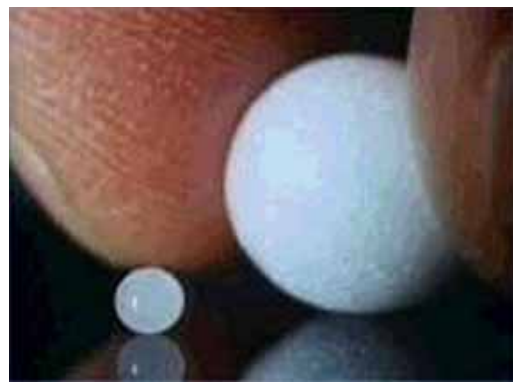
Figura 2.6 – Perola de poliestireno – EPS (expansão)
