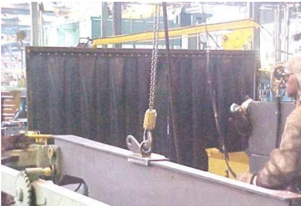
Foto 22: Iça Longarina: Movimentos de peças feitos por meio de talha mecânica giratória; evitando-se riscos maiores para a coluna e MMSS. Mesmo assim podendo causar lombociatalgia pelo tempo prolongado que permanece de pé.
