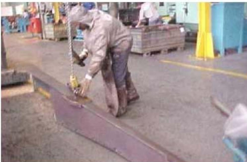
Foto 24: Posiciona peça na empilhadeira. Demonstração do encaixe. Flexão da coluna lombar com discreta flexão de joelho, por curto período de tempo.
