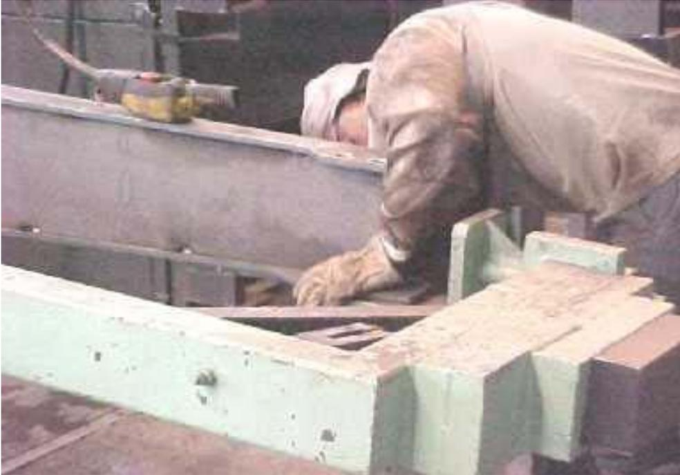
Foto 20: Fixa Longarina: tronco excessivamente curvado, posição estática. Corpo fora do eixo natural podendo ocasionar problemas em coluna.
