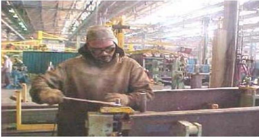
Foto 9: Fixa chapa superior – enroscar o parafuso. Movimento de mão e ombro; cotovelo em semi-flexão. Predisposição: cervicobraquialgia, epicondilite, tendinite do supra-espínho, LER/DORT.
