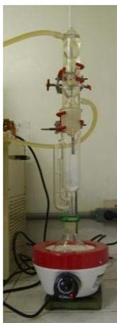
Figura 4.2 – Foto do sistema Soxhlet.
