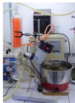
Figura 4.3 – Foto do rotaevaporador
