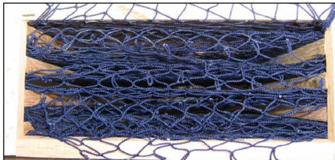
Figura 4.6 – Rede de Nylon fixada em uma armação de madeira
