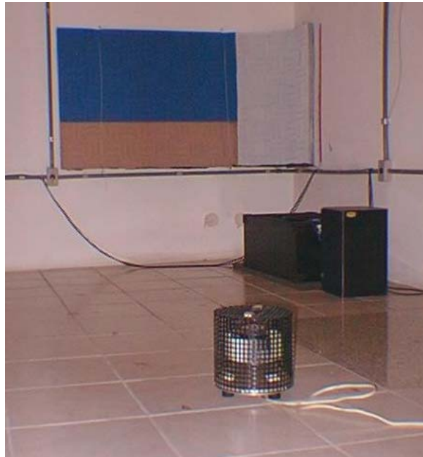
Figura 59 - Foto da fonte sonora Vibranihil na câmara de 83 \text{ m}^3 do LVA-UFSC; ao centro abaixo. Também caixas acústicas e painel com espumas de absorção sonora; aos fundos e acima.
