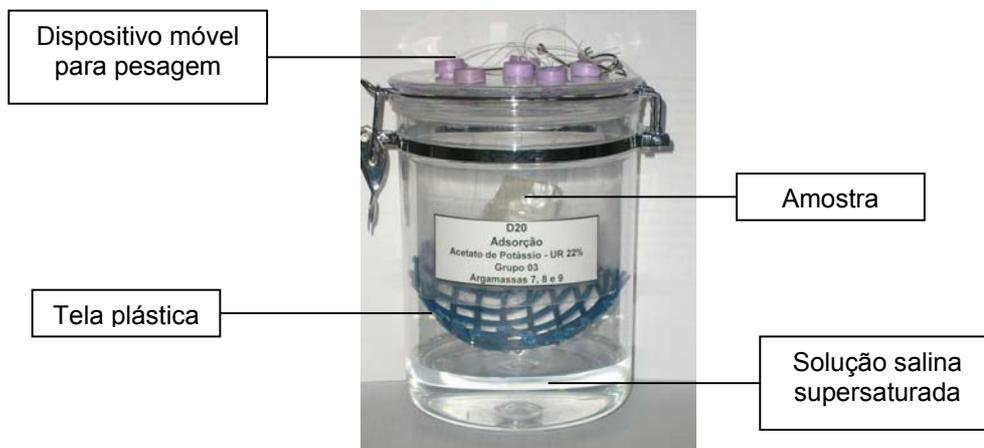
**Figura 4.6- Aparato experimental adotado nos ensaios de adsorção x dessorção**
