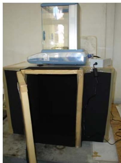
**Figura 4.7– Balança usada para pesagem das amostras nos ensaios de adsorção x dessorção**
