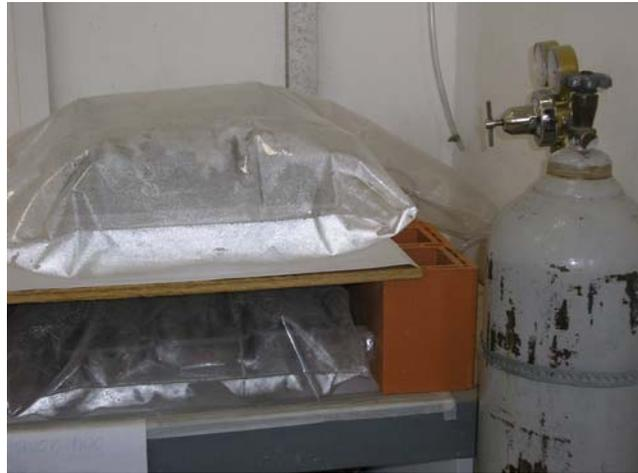
**Figura 4.3-** Balão preenchidos com gás  $N_2$ , utilizados para cura dos corpos de prova
