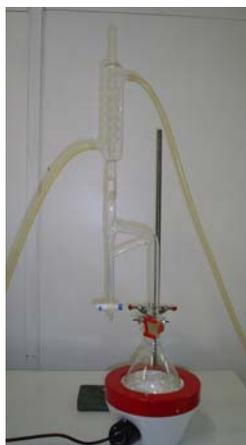
Figura 11: Esquema do equipamento de hidrodestilação utilizado na extração de óleo de hortelã
