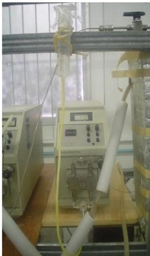
Figura 15: Foto da bomba de co-solvente acoplada ao equipamento de ESC 1.
