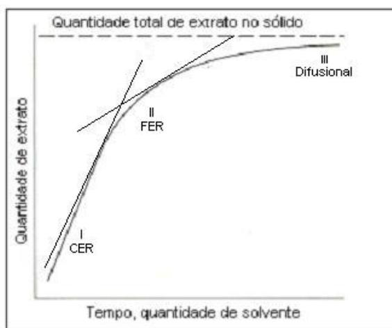
Figura 6: Curva típica de extração (BRUNNER, 1994), com duas retas ajustadas.
