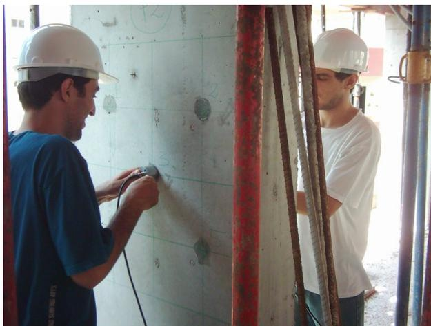
*Figura 4.12 – Utilização do ultra-som em estruturas de concreto in loco*
