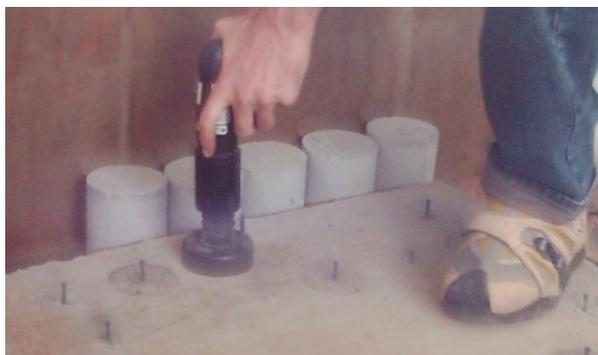
*Figura 4.7 – Execução do ensaio de penetração de pinos*
