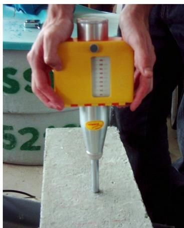
*Figura 4.6 – Esclerometria na face superior de prismas e laje*
