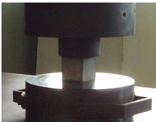
*Figura 4.10 – Ensaio à compressão dos corpos-de-prova cúbicos para  $E_a$*
