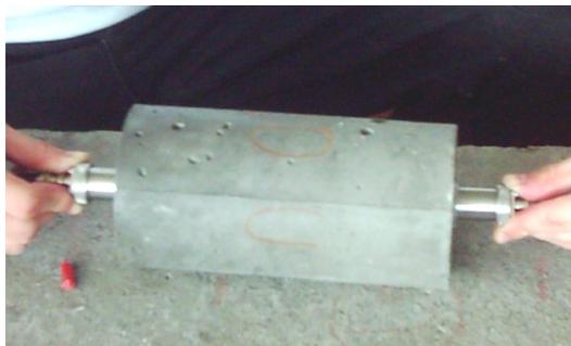
*Figura 4.2 – Aplicação do ultra-som em corpos-de-prova cilíndricos no modo direto*
