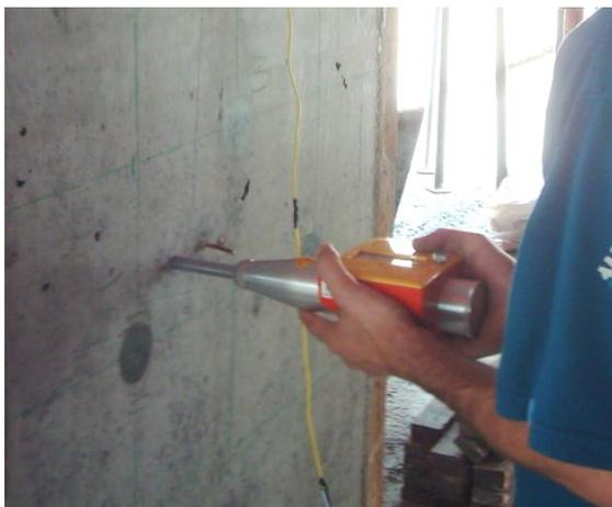
*Figura 3.5 – Utilização do esclerômetro em estrutura de concreto*
