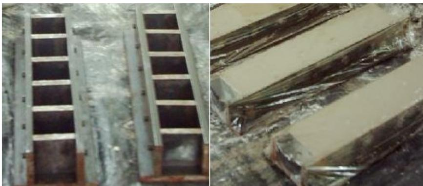
*Figura 4.9 – Moldagem dos corpos-de-prova cúbicos para ensaios de  $E_a$*
