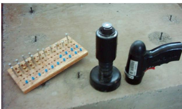
*Figura 4.8 – Equipamento utilizado no ensaio de penetração de pinos*
