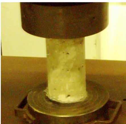
Figura 4.1 - Ensaio de resistência à compressão
