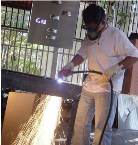
Fig. 10 – mesa de corte e tocha de plasma.
