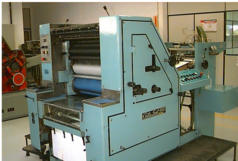
Foto 1: Máquina impressora offset CATU SET 660.
