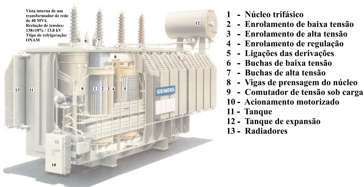
Figura A.1: Transformador de potência trifásico (CATÁLOGO: SIEMENS, 2006)
