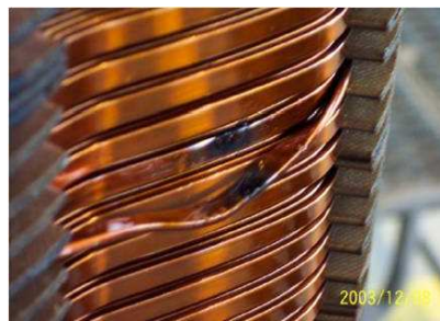
Figura 2.7: Curto-Circuito entre espiras de um enrolamento
