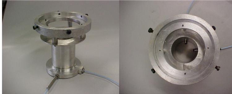
Figura 3.6 – Dispositivo para medição de deflexão de haste de fresas.
