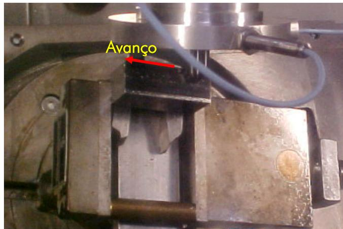
Figura 3.10 – Usinagem do corpo de prova.
