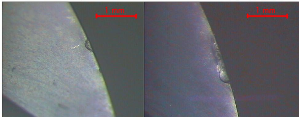
Figura 2.24 – Crateras típicas surgidas em fresas de metal-duro no fresamento de titânio.
