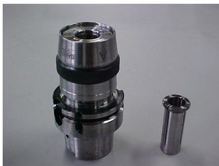
Figura 3.5 – Mandril e pinça utilizados para a fixação da fresa.
