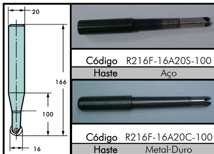
Figura 3.2 – Fresas de topo esférico utilizadas com suas dimensões em mm.
