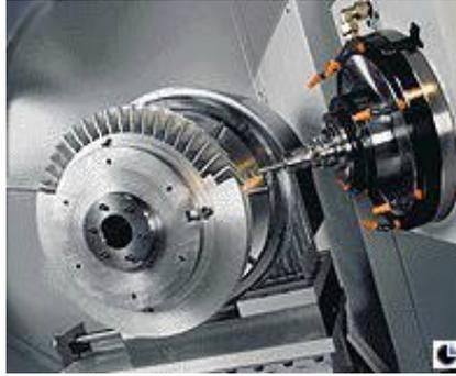
Figura 2.1 – Fresamento em 5-eixos simultâneos de um BLISK [14].
