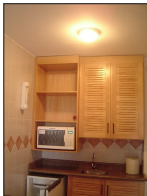
Foto - parte da iluminação das UH'S é feita com lâmpadas incandescentes.
