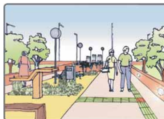
Figura 84 – Faixa de pedestres com ilha de mobiliários. Fonte: Acervo Próprio
