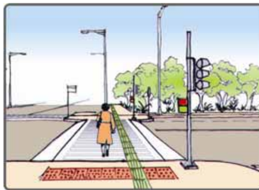
Figura 81 – Travessia elevada com semáforo para pedestres.
