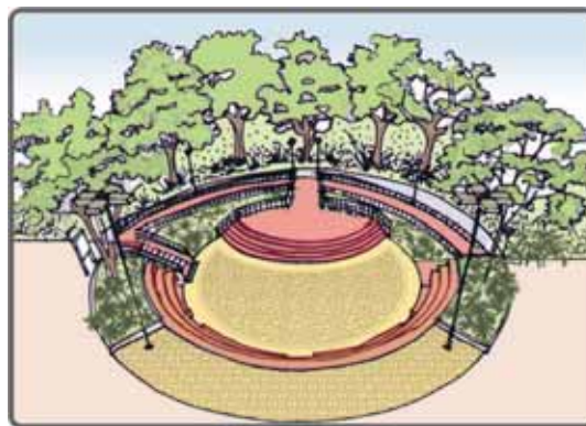
Figura 96 – Espaço para espetáculos implantado abaixo do nível da área livre, com acesso por rampa e escada.
