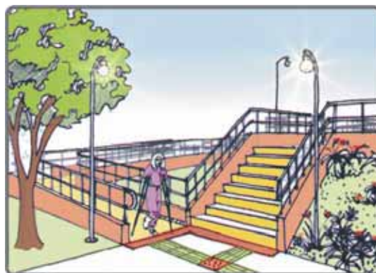
Figura 86 – Rampa e escada associadas. Fonte: Acervo Próprio
