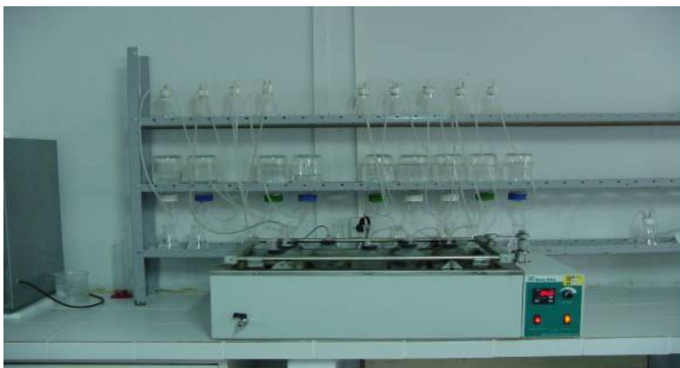
Figura 4.6. Esquema e foto do sistema ENQ-UFSC utilizado para os testes de biodegradabilidade
