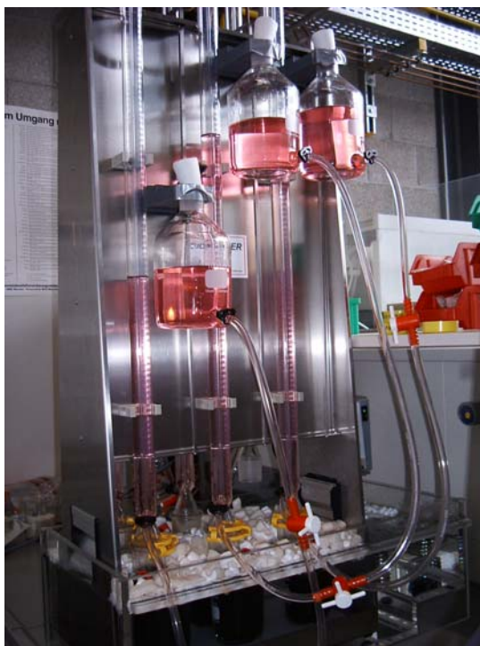
Figura 4.5. Aparelho usado para os ensaios de biodegradabilidade – Eudiometer
