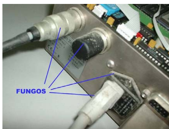
Figura 35 - Fungos localizados na parte posterior do módulo de comando do LASER YAG .
