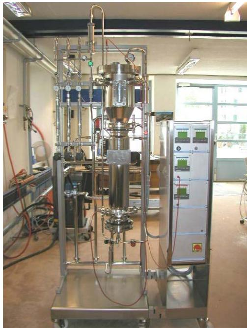
Figura 3.7 Biorreator *airlift* com circulação interna fabricado pela Bioengineering (Cortesia: Daniela M. Soares - Micronal S.A., 2003).
