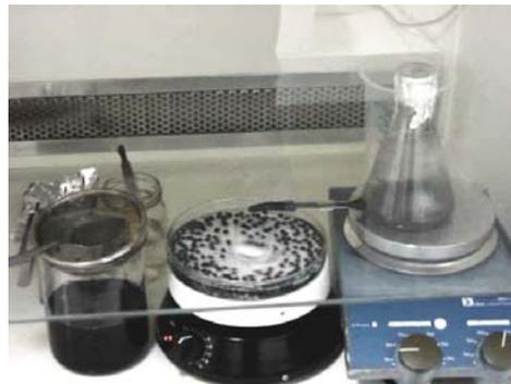
Figura 5.53 Dispositivo de encapsulamento da biomassa em gel de alginato de cálcio. A distribuição uniforme da biomassa foi garantida através da agitação constante.
