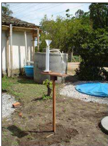
Figura 25: Pluviômetro instalado na residência em estudo.
