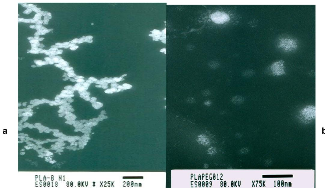
**Figura 7.** Micrografias obtidas por MET das nanocápsulas de PLA (a) e PLA-PEG 49 kD (b) contendo CPT.
