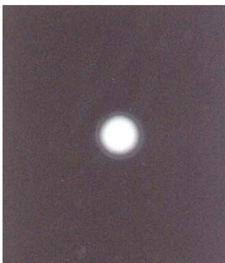
**Figura 15.** Micrografia obtida por MET a partir de suspensão de nanocápsulas contendo pireno.
