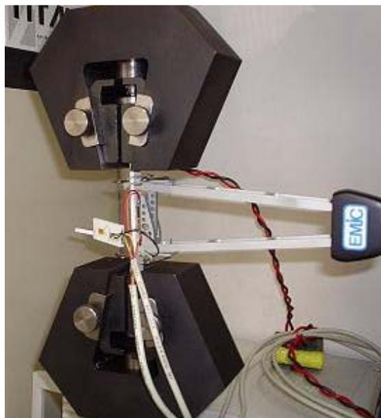
Figura 4.1: Ensaio de tração em PVC realizado na máquina Emic modelo DL3000.
