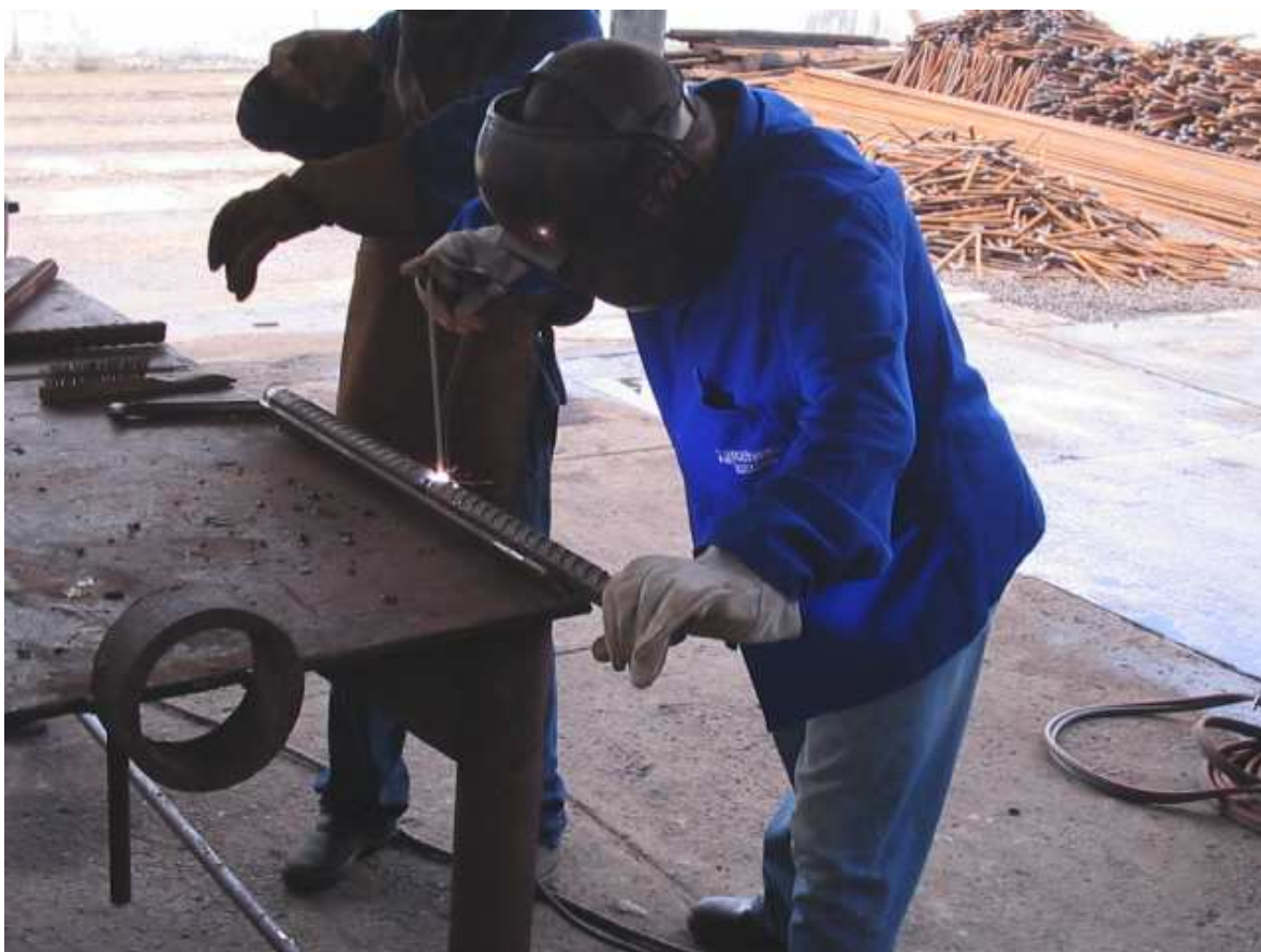
Fig.3.2.8- Soldagem dos Corpos de Prova das Barras Nervuradas de Aço CA-50.
