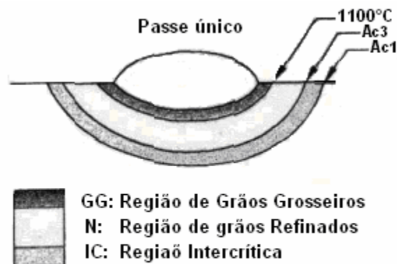
Figura 2.3.1 - Nomenclatura das diferentes regiões da ZTA de um passe único [11].
