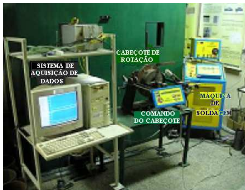
Fig.3.2.4–Bancada do Labsolda/ UFSC para soldagem dos cordões circunferenciais.
