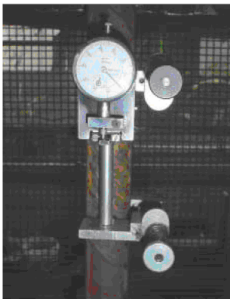
Fig. 3.1.2 - Detalhe do extensômetro acoplado na barra identificada como "Lado B" para determinação do limite de escoamento
