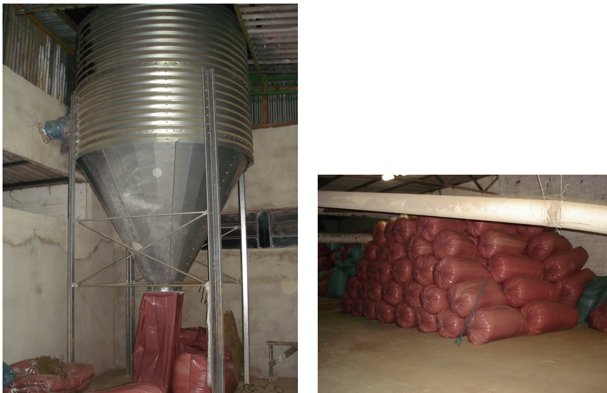
Figura 50 - Silo que recebe os flocos triturados de EPS para posterior ensacamento.
