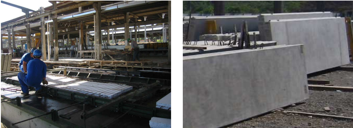
Figura 41 - Produção e aspecto final de um painel pré-fabricado tipo sanduíche.
