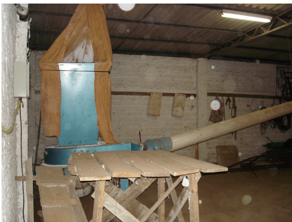
Figura 49 - Vistas interna e externa do moinho e da tubulação que leva os flocos triturados até o silo.
