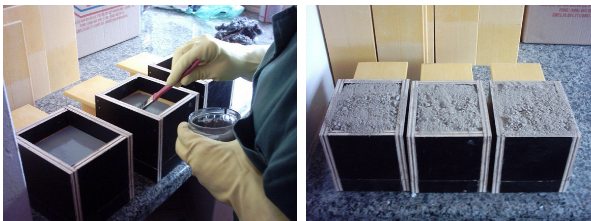
(a) (b) FIGURA 6.11 – (a) Aplicação da camada de areia sobre o perfil, para a interface com Sikadur 32 Gel; (b) Cura dos corpos-de-prova no laboratório.
