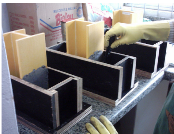
FIGURA 6.12 – Aplicação da camada de Sikadur 31 sobre o perfil.
