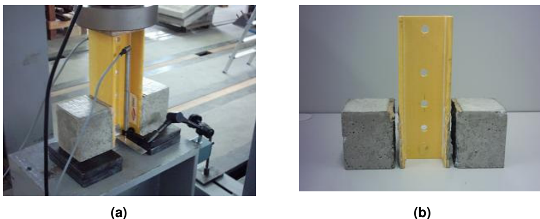
FIGURA 6.8 – Ensaio piloto de aderência concreto/PRFV: (a) dispositivo do ensaio e (b) ruptura do corpo-de-prova.
