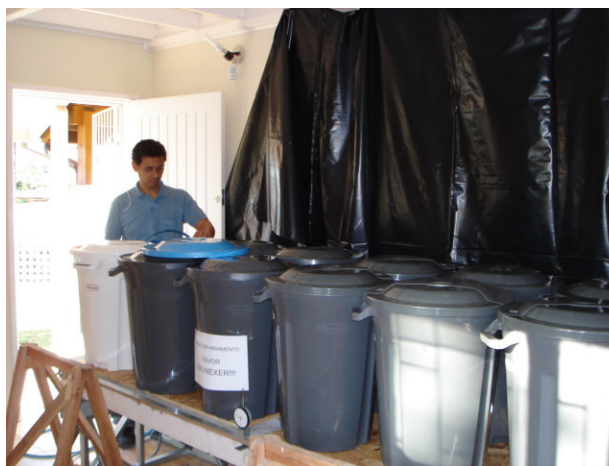
FIGURA 7.39 – Enchimento dos baldes com água para o carregamento de longa duração.
