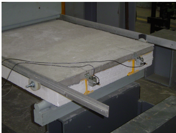
FIGURA 7.13 – Detalhe da fixação do LVDT WI-10 para medição do deslocamento relativo concreto/PRFV e apoio da régua de alumínio.
