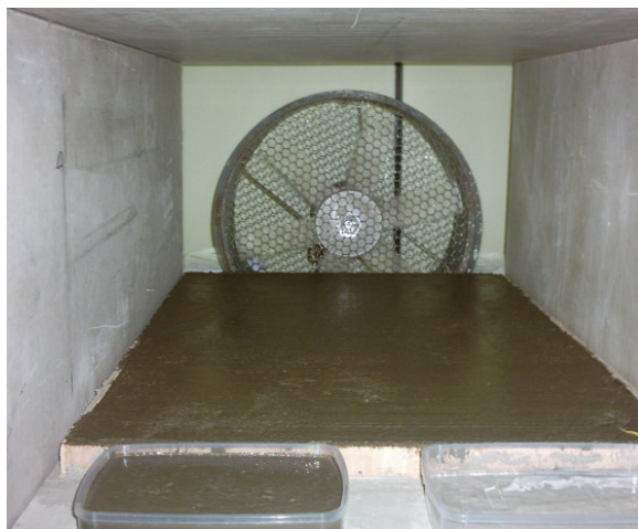
FIGURA 5.6 – Vista do túnel de vento com o exaustor e a placa de argamassa.
