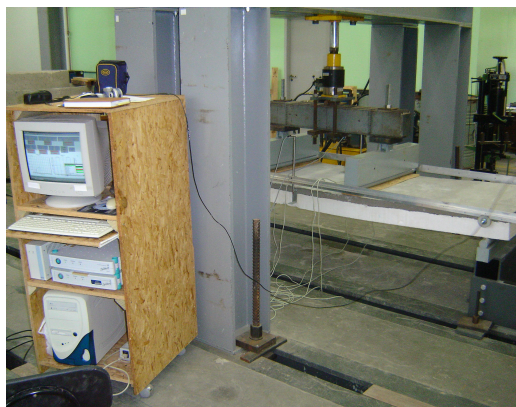
FIGURA 7.16 – Sistema de aquisição de dados em funcionamento durante ensaio da laje mista.
