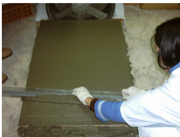
FIGURA 5.5 – Nivelamento da placa de argamassa.
