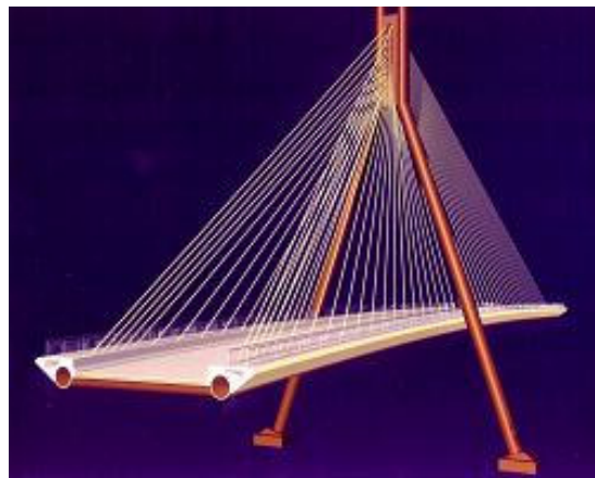
FIGURA 2.46 – Desenho esquemático do viaduto estaiado I-5/Gilman em materiais compostos avançados. Fonte: BURGUEÑO et al. (2000).
