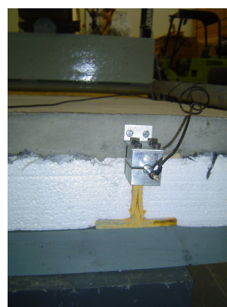
FIGURA 7.24 – Ruptura na alma de um dos perfis pultrudados na Laje Mista 03.
