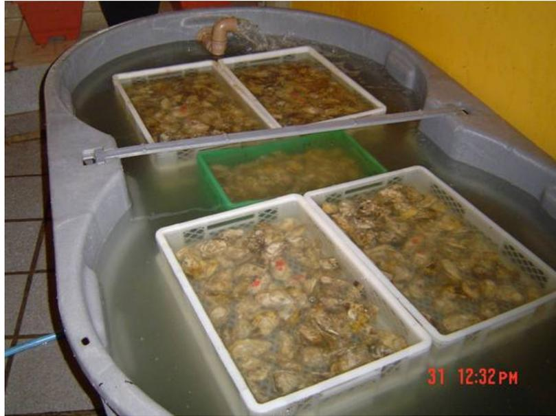
Figura 4: Disposição das caixas com ostras no tanque de depuração; 20 caixas dispostas em 5 colunas com 4 andares.
