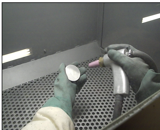
Figura 26 – Jateamento com abrasivo óxido de alumínio em cabine de jateamento manual.
