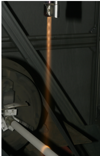
Figura 15 – Sistema de aspersão térmica pelo processo HVOF. Pistola JP 5000. Acervo Franco Wronski Comeli (2006).
