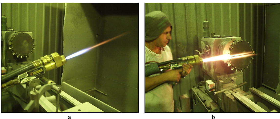
Figura 29 – Aspensão térmica HVOF dos corpos de prova.
