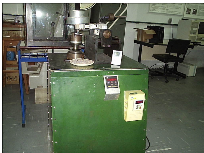
Figura 32 – Tribômetro pino sobre disco da FITEJ de Joinville.
