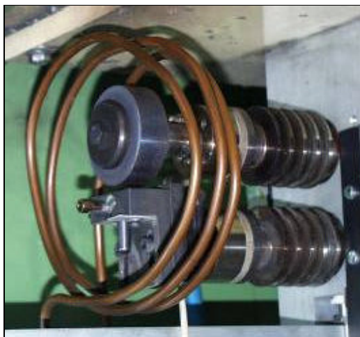
Figura 20 – Sistema de aquecimento de alta frequência ajustado ao Tribômetro.
