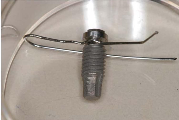
**Figura 1: Implante immobilizado por meio de grampo metálico estéril**
