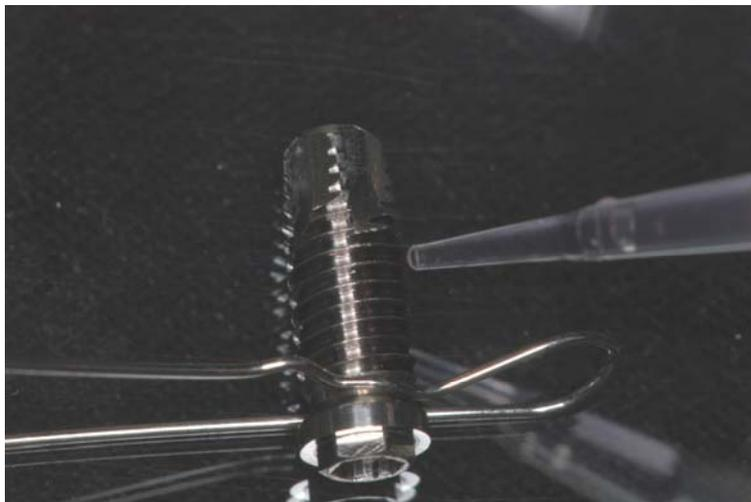
**Figura 2: Células sendo semeadas sobre a superfície do implante,  $1 \times 10^4$  células**
