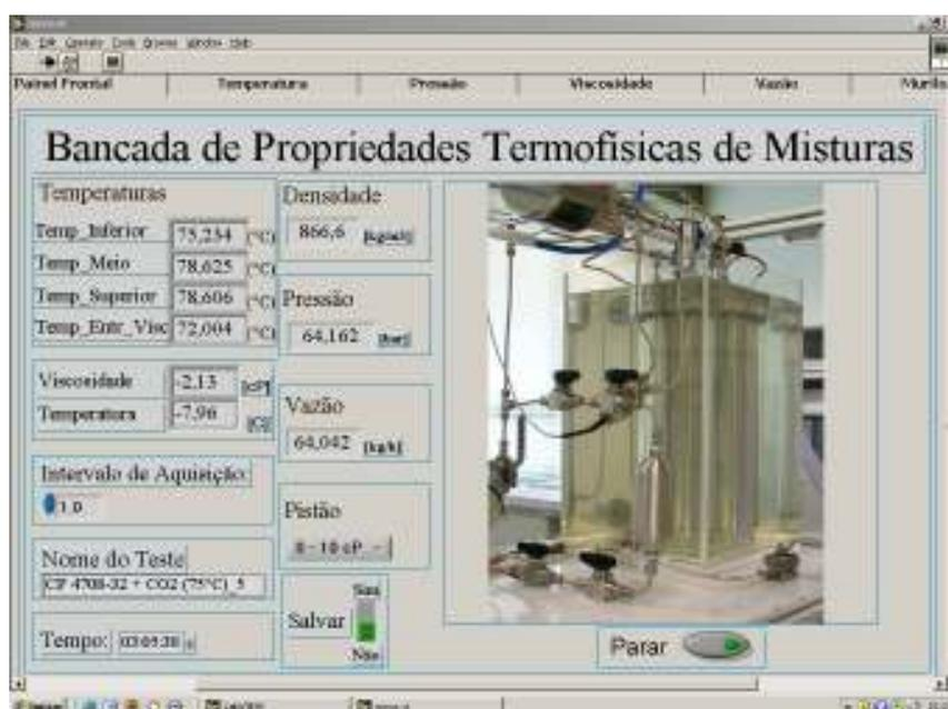
Figura 3.3 Interface do ambiente gerado em Labview para aquisição e tratamento dos dados experimentais.
