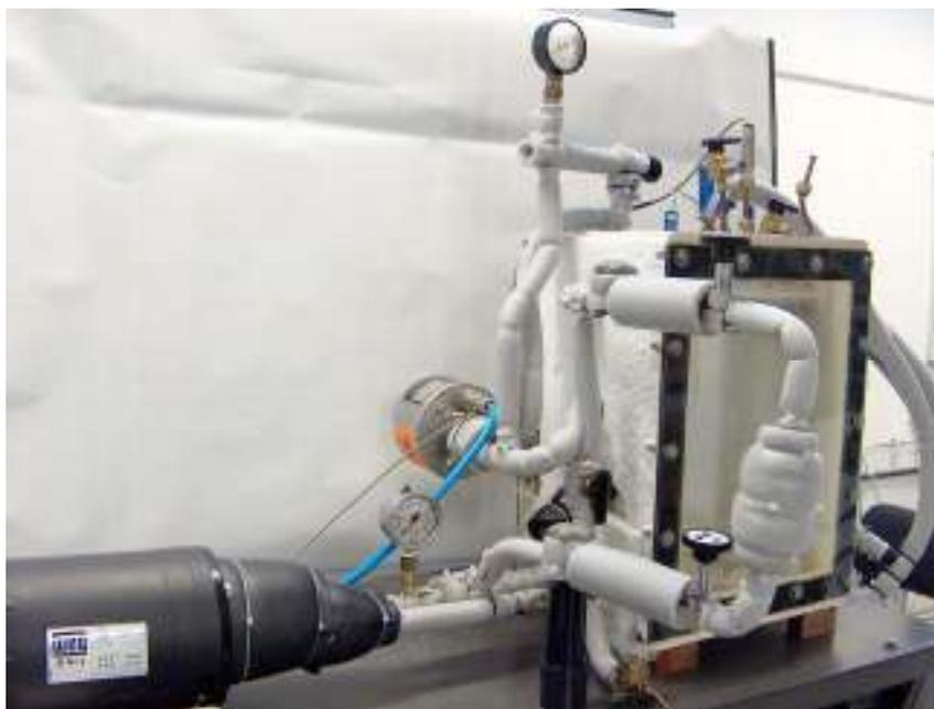
Figura 3.2 Bancada de Propriedades Termofísicas para pressões de até 15 bar.
