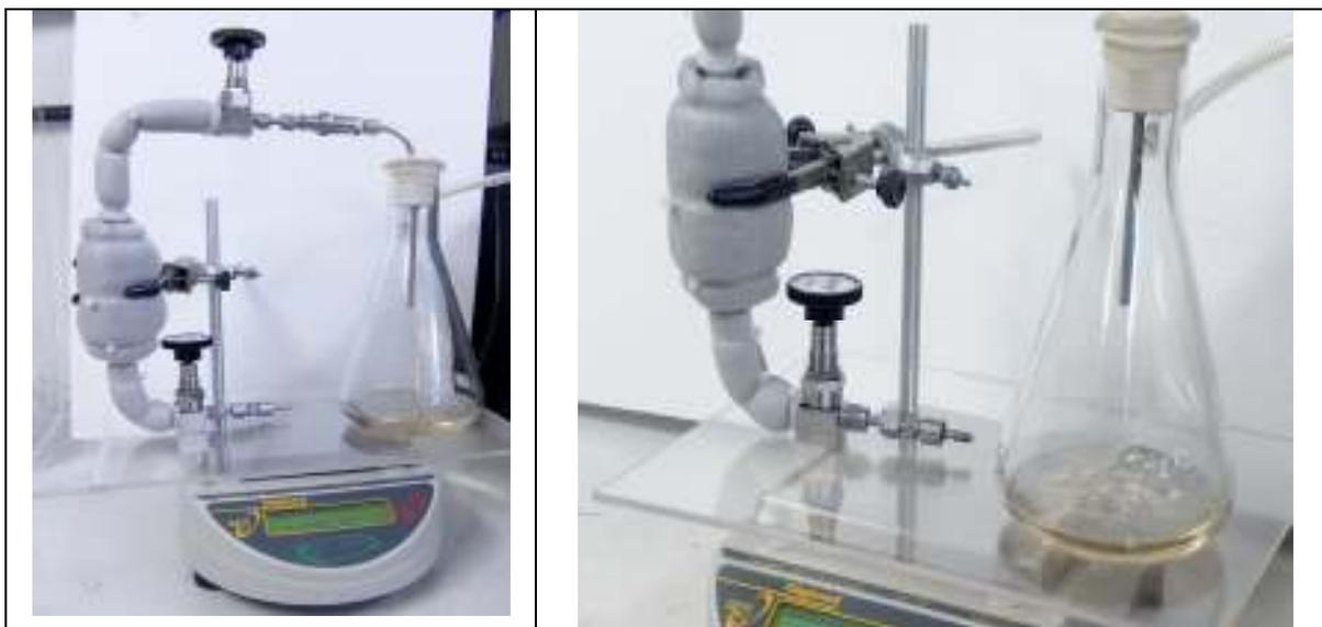
Figura 3.8 Aparato experimental utilizado para medição de solubilidade a baixas pressões.
