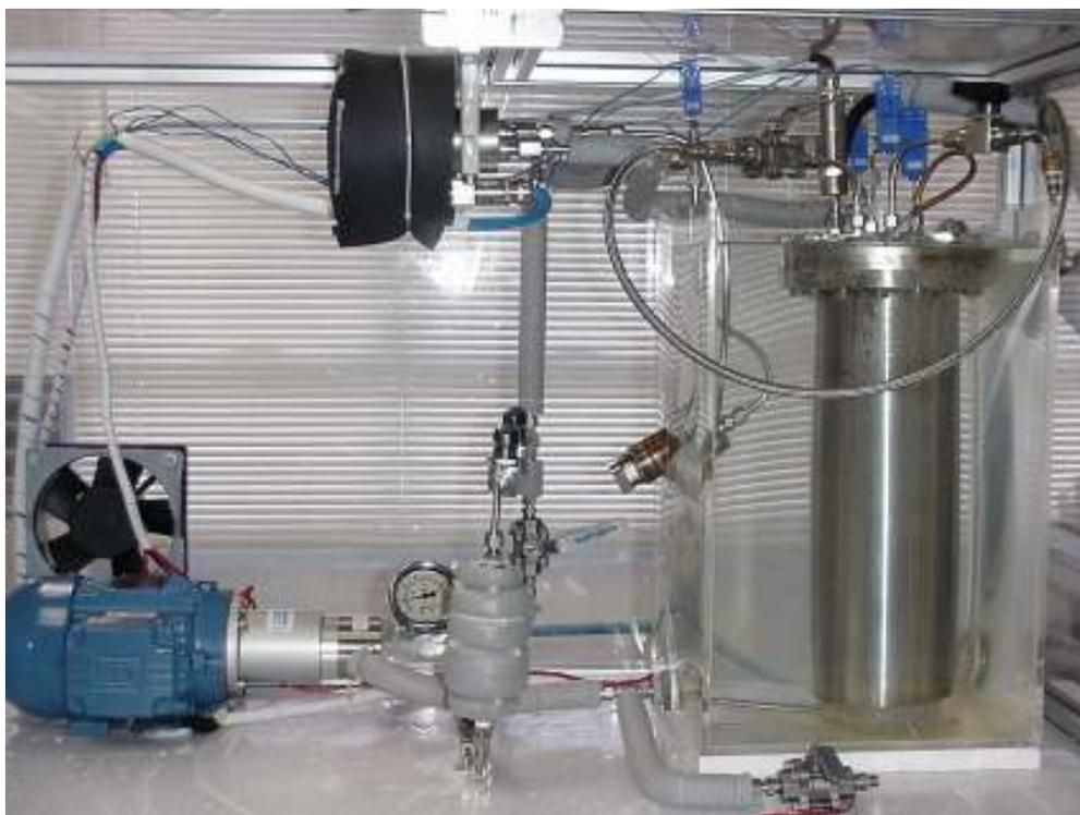
Figura 3.9 Bancada de Propriedades Termofísicas para pressões de até 125 bar.
