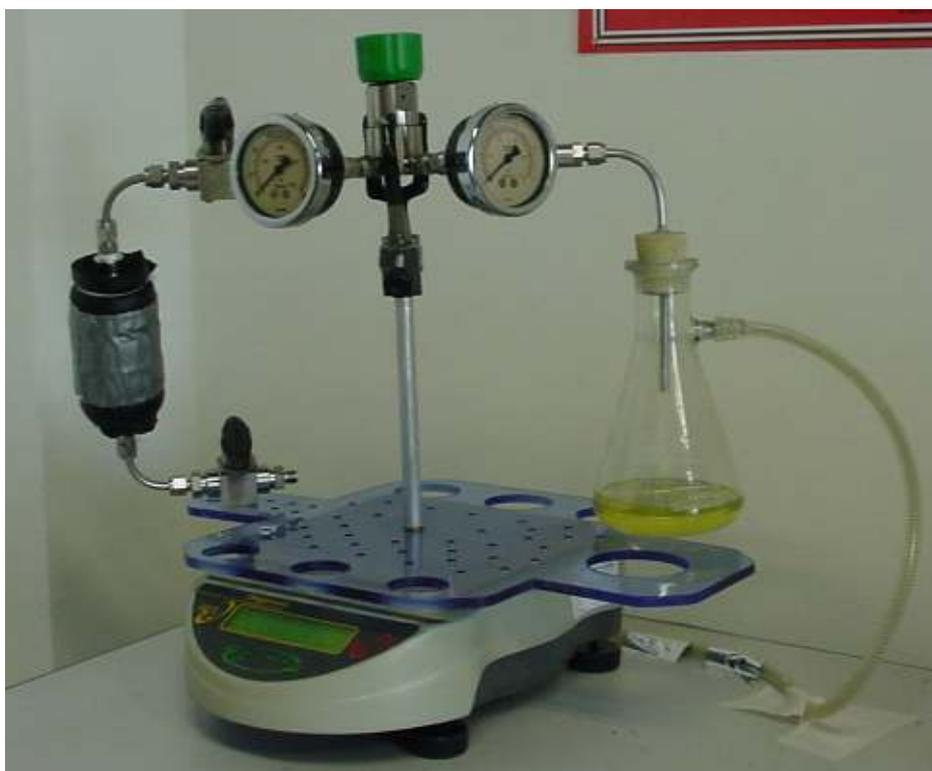
Figura 3.11 Aparato experimental para medir solubilidad (até 125 bar).
