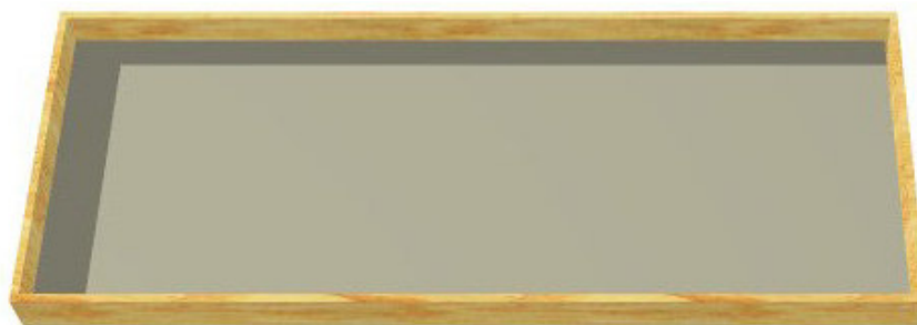
Figura 4. 3: base de 20mm de argamassa.
