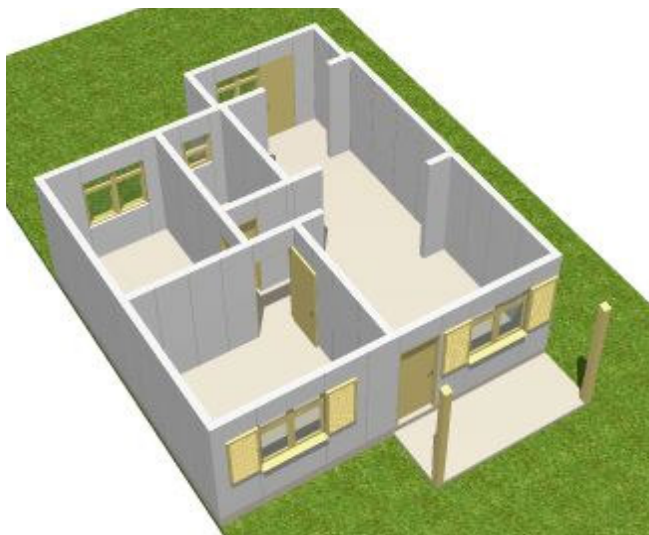
Figura 3. 5 : montagem dos painéis de parede
