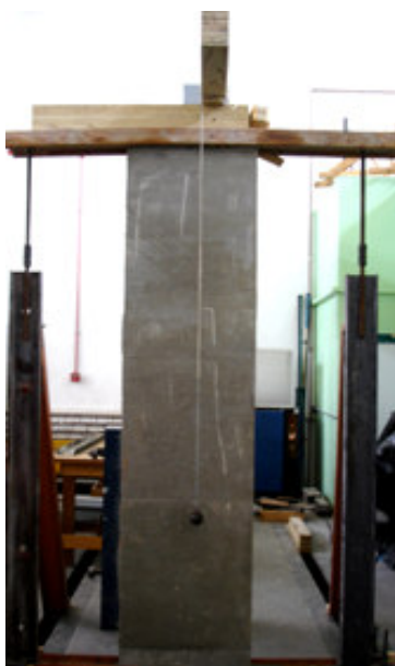
Figura 5.3 : ensaio para impactos de corpo duro com esfera de 1kg.
