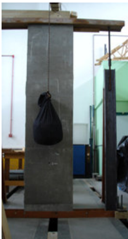
Figura 5.7 : arranjo do ensaio para impactos de corpo mole com saco de areia de 40kg.
