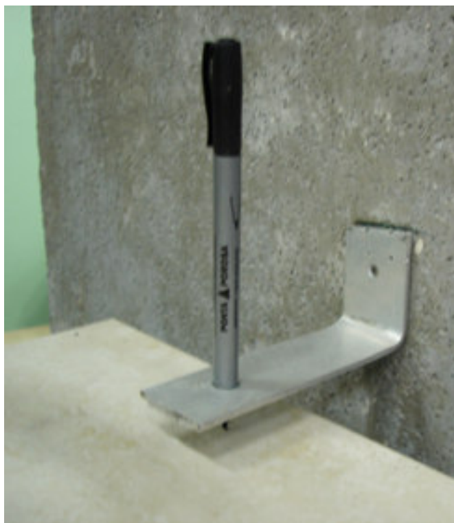
Figura 5.8 : dispositivo de registro de deslocamentos horizontais na face oposta do painel.
