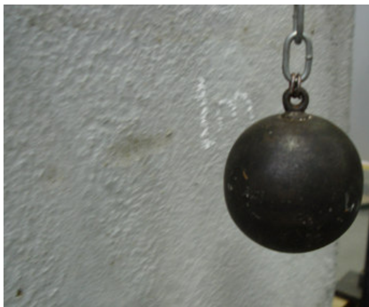
Figura 5.4 : esfera de 1kg para os ensaios de impacto de corpo duro
