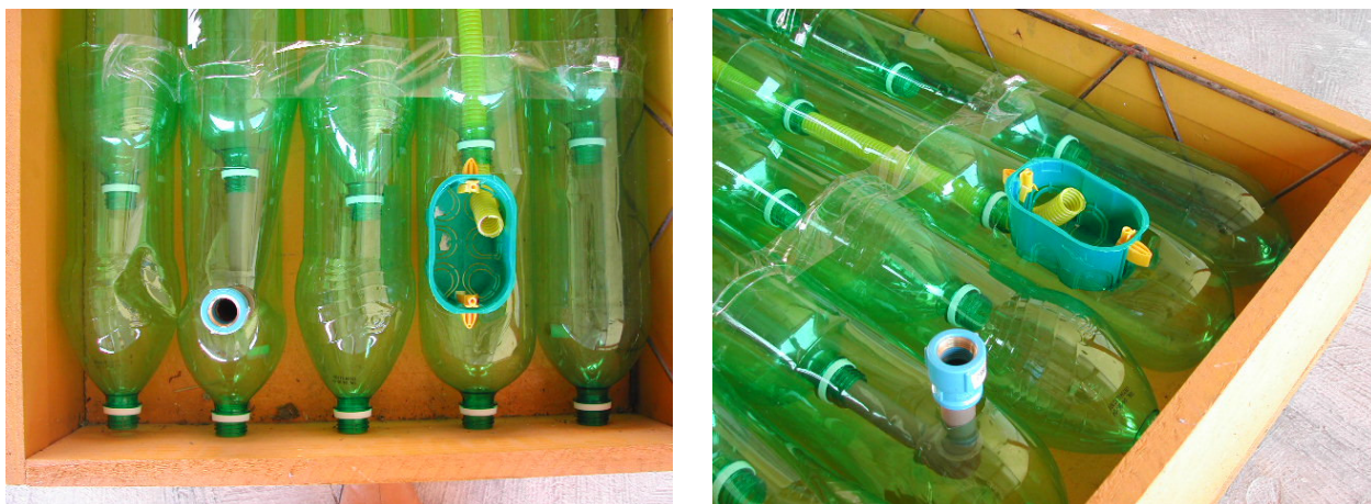
Figura 4. 9: painel com instalação elétrica e hidráulica.
