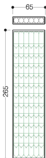
Figura 5.1 : planta e elevação do painel de parede analisado.
