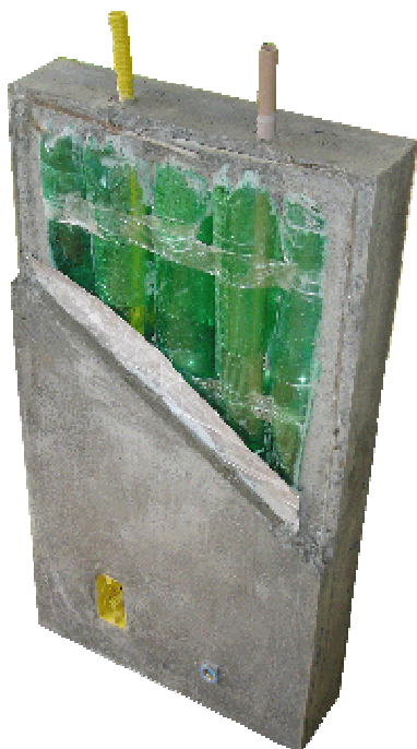
Figura 4. 10: painel com instalação elétrica e hidráulica. Fonte: Brasiltec (2005).
