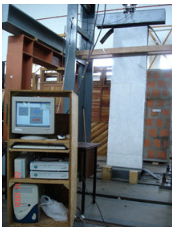
Figura 5.11 : painel posicionado no pórtico de ensaios e sistema de aquisição de dados.
