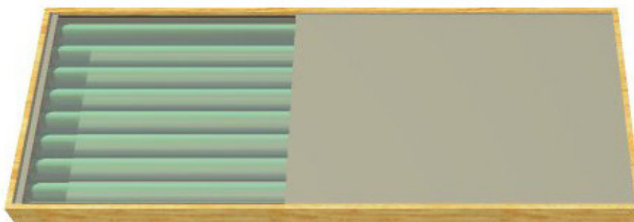
Figura 4. 5: revestimento das laterais e da superfície do painel.
