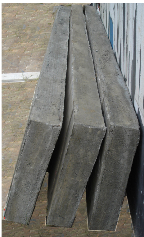
Figura 4. 47: armazenagem do painel de parede por 28 dias para realização de ensaios de desempenho estrutural.
