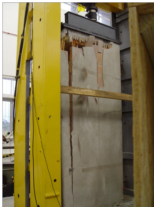
Figura 5.20 : Ruptura do painel 8. Fonte: Casas Industrializadas Dominó – Parte 2.
