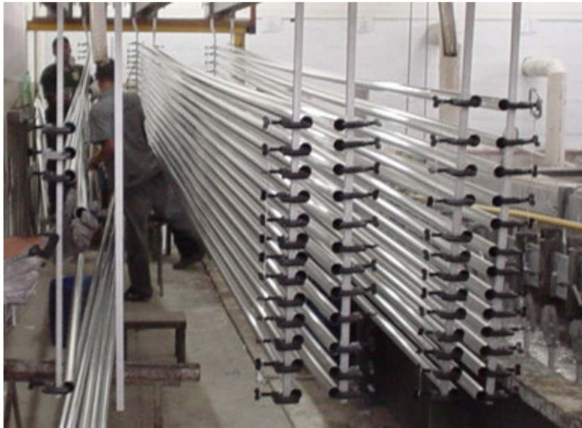
Figura 2 – Montagem das peças a serem anodizadas (Anodilux, 2005 ).
